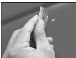
Paso 1: Masilla para picaduras
